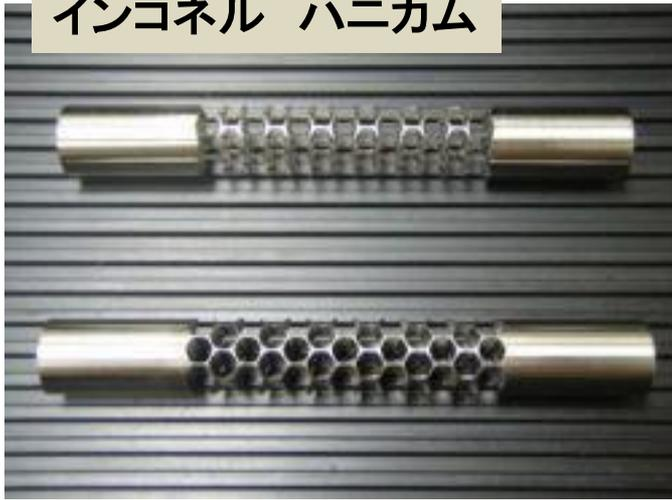
残した肉厚は0.2mm。加工を進めるに従いワークの剛性が落ちていくため、工具の切れ味、機械の精度・制御方法、プログラミング、全てにおいて非常に高度な技術が要求される。
