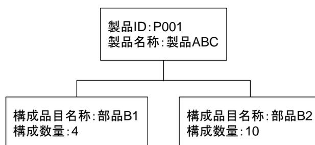
図 2-2 対象とする製品の構造
